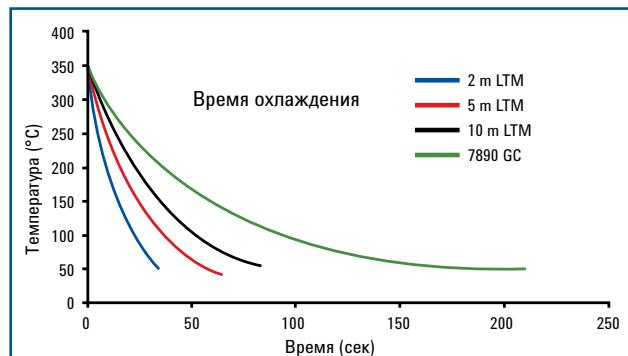
Время охлаждения для стандартных (5-дюймовых) модулей колонок LTM значительно меньше, чем при использовании традиционного термостата для ГХ.
