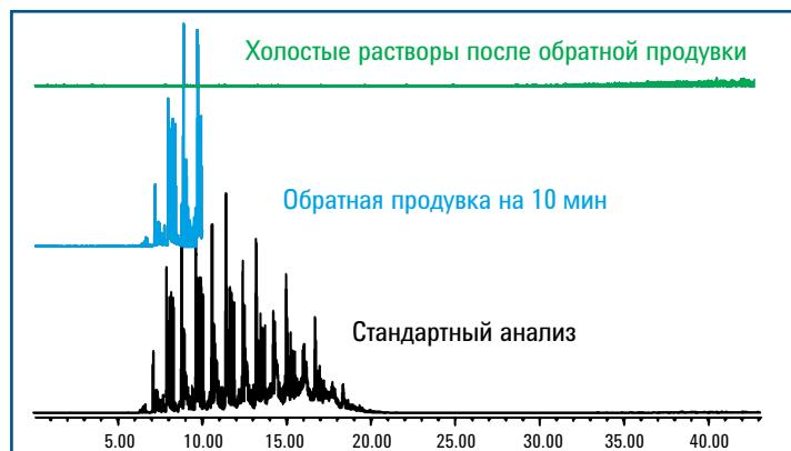
5989–9804EN: Технология капиллярных потоков — обратная продувка — сокращение времени выполнения анализа и увеличение производительности лаборатории
