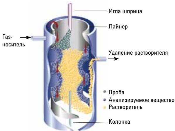
5990-3954EN: Испаритель с программированием температуры Agilent для газовой хроматографии
