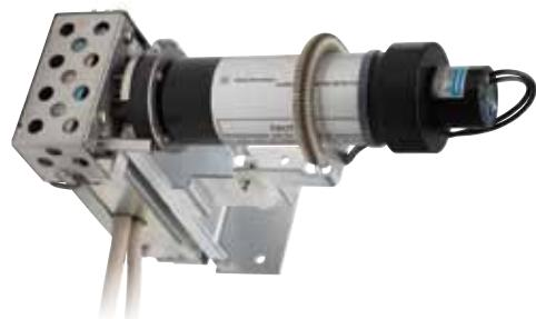
**Надежный анализ наличия серы на следовом уровне. Непревзойденная воспроизводимость результатов была достигнута за счет совместного использования ГХ Agilent 7890B с чувствительным высокотемпературным ПФД.**
