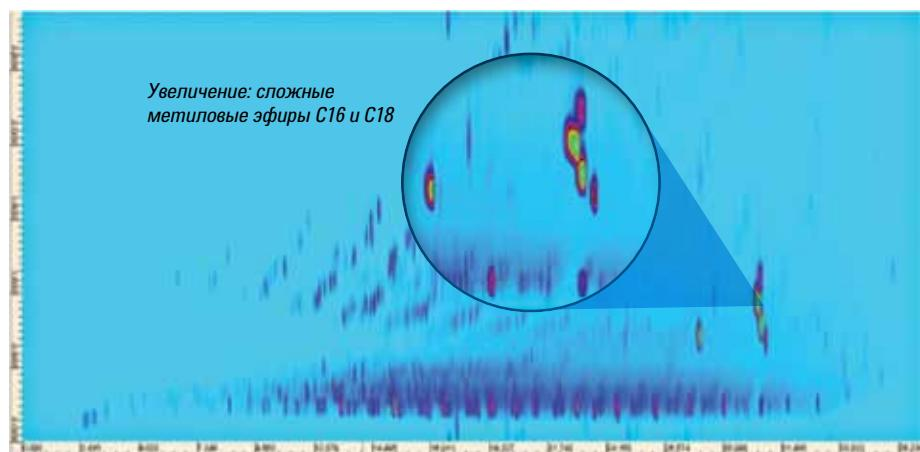
5989-9889EN: Технология капиллярных потоков — модулятор расхода ГХ x ГХ: второе измерение для сложных смесей
