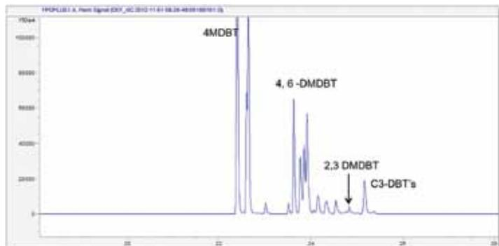
Анализ замещенных дibenзотиофенов в легкой фракции нефти с помощью технологии капиллярных потоков Deans Switch с ПФД Agilent 7890B. Этот анализ позволяет повысить разделение и снижает возможность гашения из-за совместного элюирования с углеводородами.
