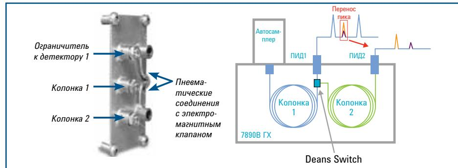
В данном примере Deans Switch позволяет перенести неразделенные следовые соединения на вторую колонку с другой стационарной фазой.
