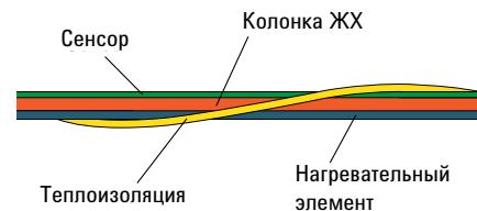
**Суть технологии LTM:** стандартная кварцевая капиллярная колонка (до 30 м) в специальной оплётке из нагревательных элементов и температурных сенсоров для сокращения продолжительности нагрева и охлаждения.
