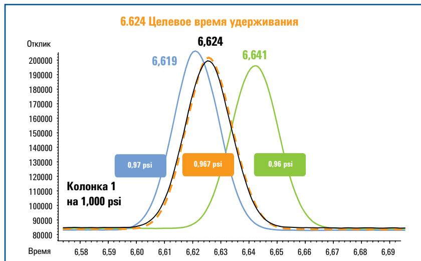
5989-8366EN: Фиксация времен удерживания при низком давлении с помощью ГХ 7890
