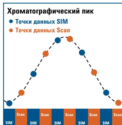
Данные режимов SIM и Scan собираются попарно в определенных временных точках, а в конце анализа создаются два отдельных сигнала данных. Каждый сигнал данных может обрабатываться как независимо полученный сигнал SIM или Scan.
